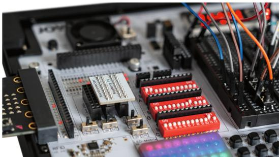
Unser Joy-Pi Advanced zeichnet sich insbesondere durch seine intelligenten Schaltereinheiten aus, die eine erweiterte Nutzung der verfügbaren Pins erlauben.
